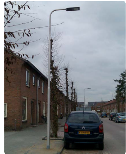
Referentiebeeld mast met enkelvoudige uithouder (lengte = 0,75 m, tilt 5°).
